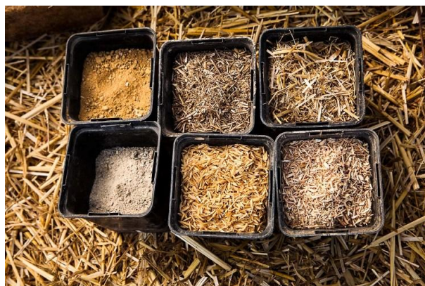
Ingrédients utilisés dans les adobes du Village (terres, sable, lavande, paille, balle de riz, copeaux)
